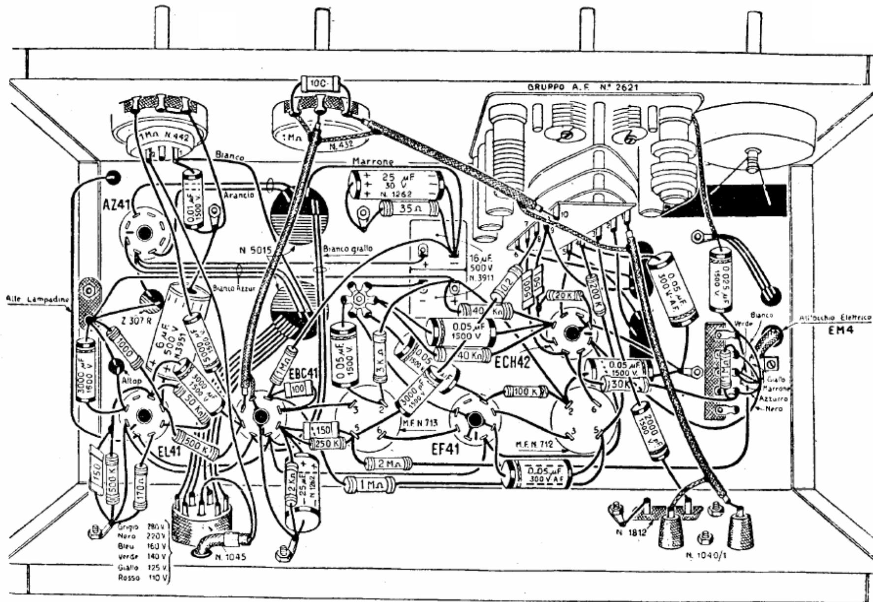
GELOSO - Super G 506 - Piano di montaggio dell'apparecchio di cui lo schema è riportato dalla figura precedente, e del quale viene fornita la scatola di montaggio.
